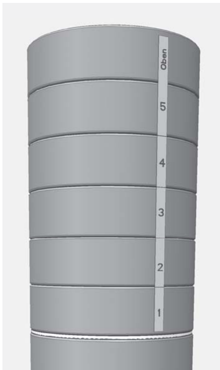
Obr. 3.15 Označení nástavce s horním odvodem kouře
