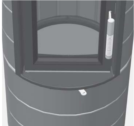
Obr. 4.4 Šoupátko spalovacího vzduchu, vpravo, zcela zavřené
