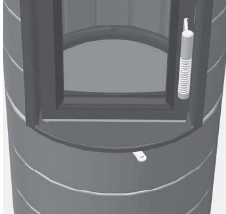
Obr. 4.5 Šoupátko spalovacího vzduchu, vpravo, zcela zavřené
